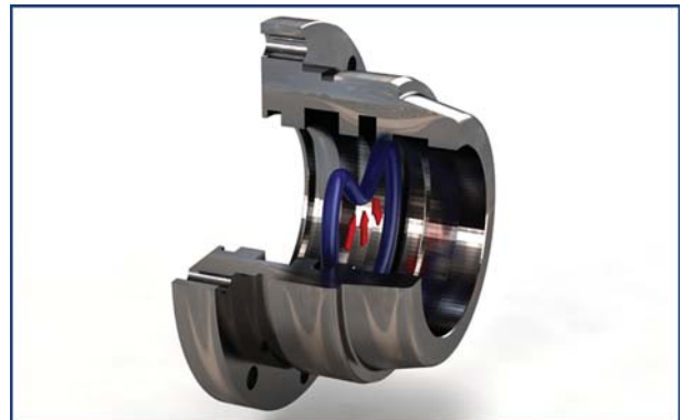
2. Montaža O-Prstena, završno pozicioniranje
