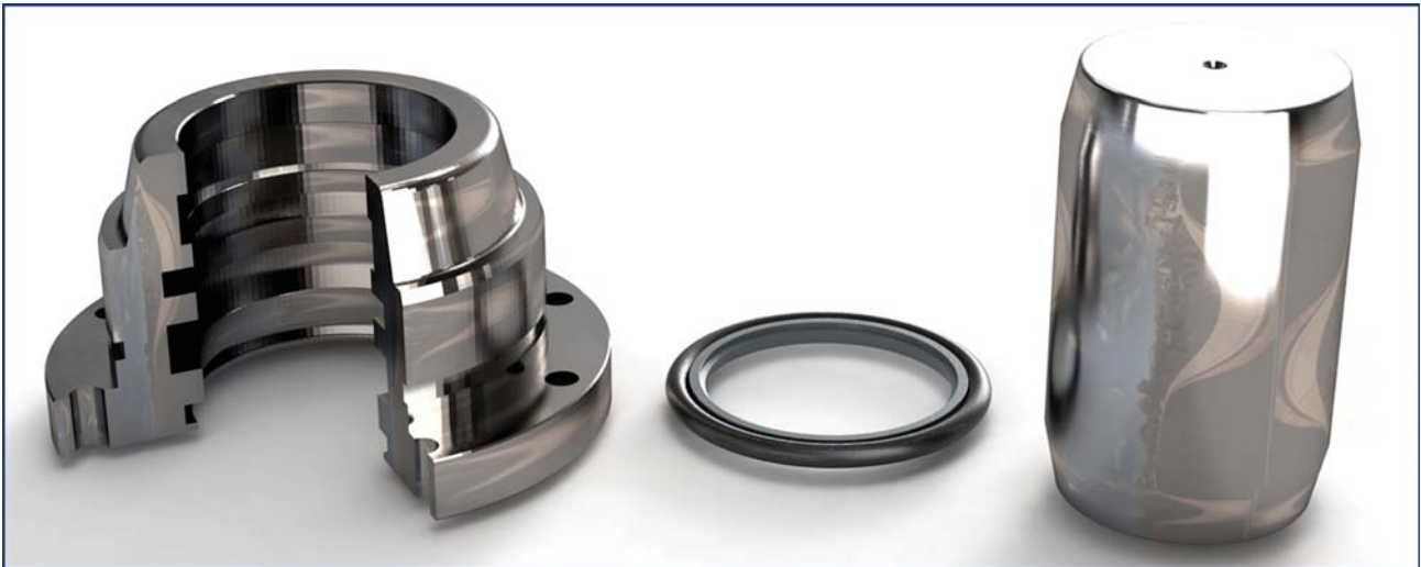
PTFE brtveni sklop tip PBS-U, pripadajuća glava cilindra i pribor za montažu (kalibracijska klipnjača sa 12° ulaznim skošenjem)
